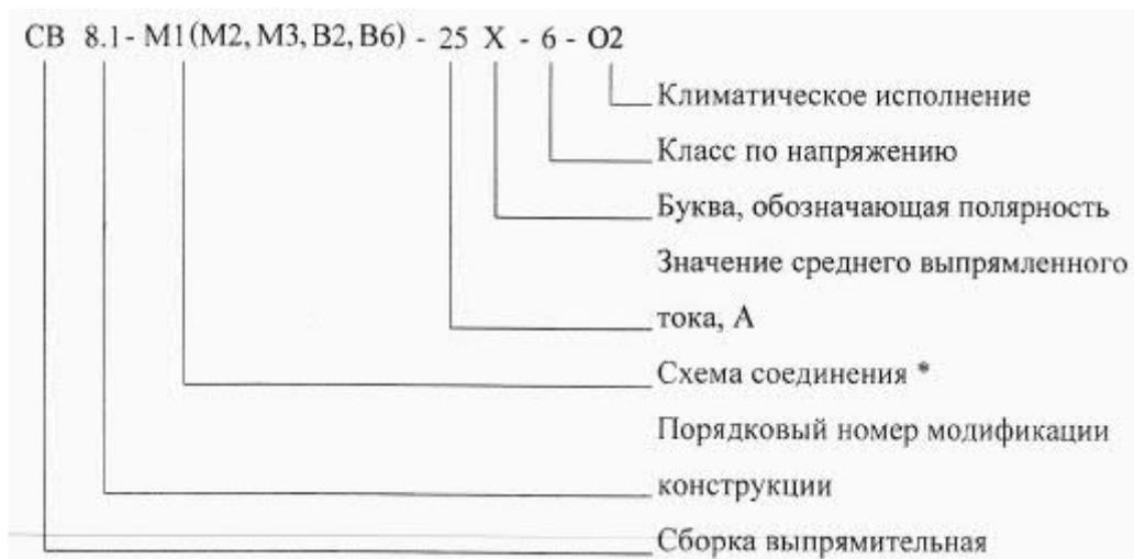
\* М1 - однофазная однополупериодная, М2 - однофазная двухполупериодная, М3 - трехфазная однополупериодная, В2 - однофазная мостовая, В6 - трёхфазная мостовая.
